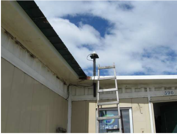
Instalación Instrumento Solar Light Modelo 501 en el techo de la Universidad de Magallanes – Sede Puerto Williams – 27 de noviembre de 2009.
