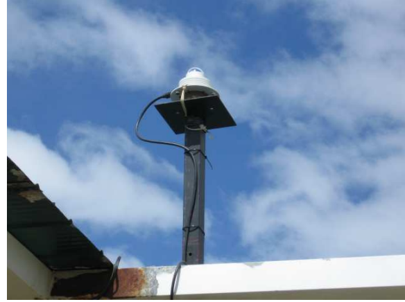
Instalación Instrumento Solar Light Modelo 501 en el techo de la Universidad de Magallanes – Sede Puerto Williams – 27 de noviembre de 2009.
